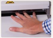
Система безопасности (автоматическое отключение опции зажима)
