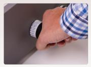
Регулятор выбора диаметра пружины
