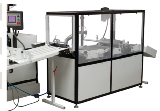
Конвейр DBW для переворачивания обложек и перекрестной сортировкой
